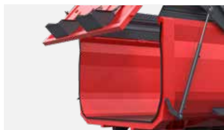
Tylna kłapa posiada uszczelkę, co gwarantuje szczelność przyczepy
