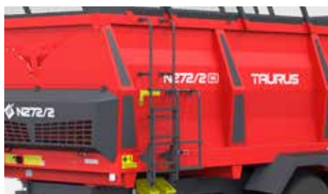
Drabinka składana zewnętrzna + wewnętrzna z możliwością demontażu
