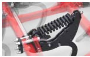
Zabezpieczenie sprężynowe - przeciążeniowe elementów roboczych
