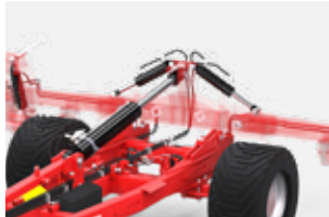
Książkowy system składania
