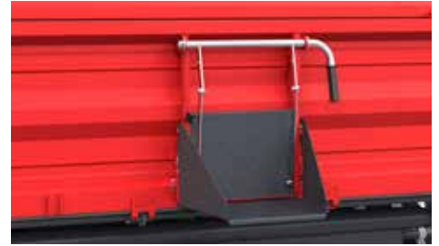
Szyber z rynną – daje możliwość precyzyjnej regulacji przepływu materiałów, co umożliwia łatwe i efektywne rozładunek zbiorów
