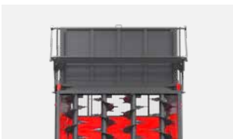
Osłona unoszona automatycznie przy podniesieniu ściany tylnej (zasuwy) (verti X4)
