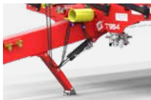
Hydrauliczna stopka podporowowa nożycowa
