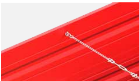
Łańcuch spinający - usztywnia ściany przestrzeni ładunkowej
