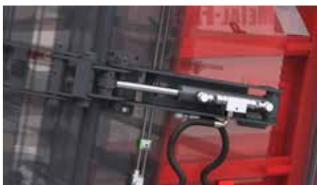
Podwójny przegub otwierania kłapy tylnej - pozwala na hydrauliczne otwieranie kłapy do 180 stopni
