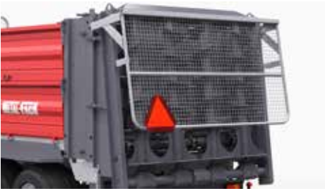
Ośłona adaptera unoszona automatycznie przy podniesieniu ściany tylnej (zasuw)
