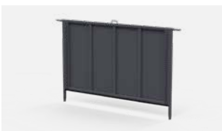
Hydraulicznie podnoszona zasawa gilotynowa, w dolnej części uszczelniona pasem gumowym
