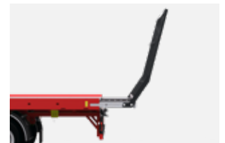
W nowej platformie do bel wysuw z 800 mm został wydłużony do 1000 mm.
