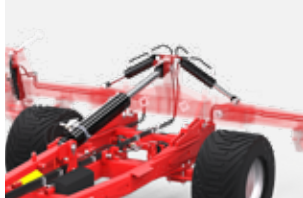
Książkowy system składania
