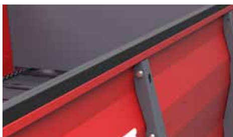
Burty osłaniane przez gumowe listwy zabezpieczające przed uszkodzeniem
