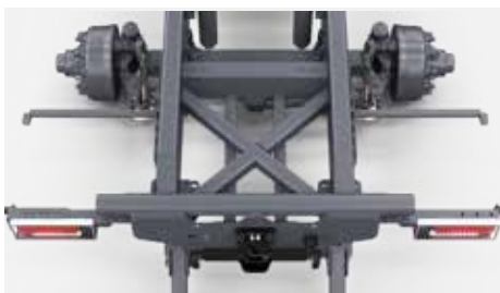
Zastrzały krzyżowe w tylnej części ramy - wzmocnienie osi wywrotu
