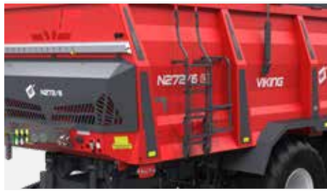
Drabinka składana zewnętrzna + wewnętrzna z możliwością demontażu
