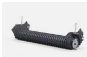
Szeroki podbieracz - szerokość robocza 1,9m, szerokość zбору 2,0m - optymalne parametry do obecnych warunków polowych
