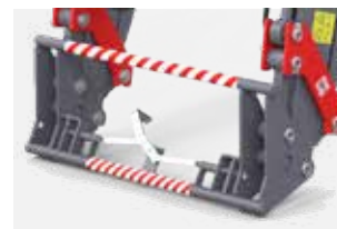
Mocowanie osprzętu - ramka EURO
