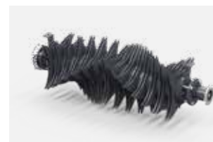
Rotor tnący czteroramienny, w kształcie V - Długość cięcia 77mm, 15 noży tnących, zabezpieczonych indywidualnie poprzez sprężyny
