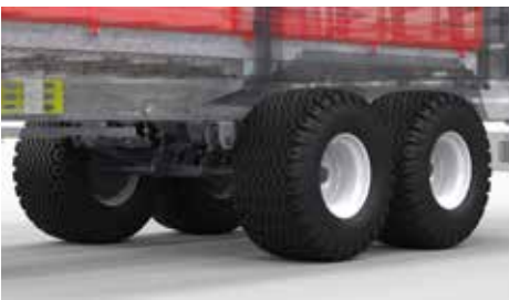
Koła 500/50-17" - zapewniają lepszą stabilność i przyczepność na różnych rodzajach terenu
