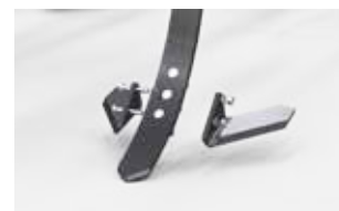
Zdjęcie lemiesz bocznych umożliwia pracę na głębokość do 30 cm
