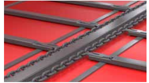
Podłoga napędzana hydraulicznie z możliwością zmiany prędkości. Łańcuch NK14 o zrywalności 21t - suma wytrzymałości wszystkich łańcuchów to 84t
