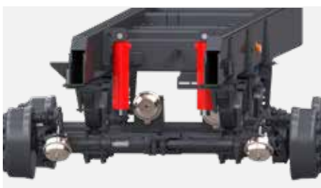
Stabilizacja hydrauliczna osi
