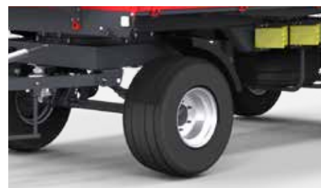
Nowe niebieżnikowane koła mają większą trwałość i odporność na uszkodzenia, co przekłada się na dłuższą żywotność i mniejszą konieczność naprawy.
