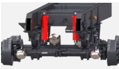
Stabilizacja hydrauliczna osi
