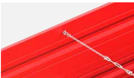
Łańcuch spinający - usztywnia ściany przestrzeni ładunkowej
