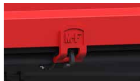
Zawiasy z logo MF - dają możliwość łatwego otwierania i zamykania burty, co ułatwia załadunek i rozładunek materiałów.
