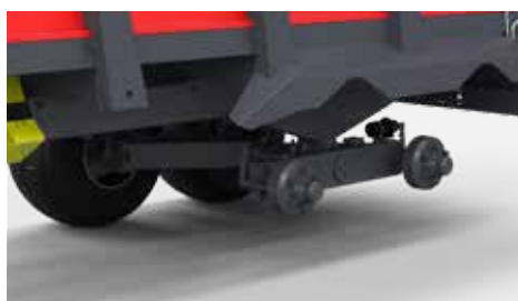
Rozrzutnik dwuosiowy typu tandem - nieresorowany (bez homologacji EU) - N267/1, N267 oraz resorowany - N267/2
