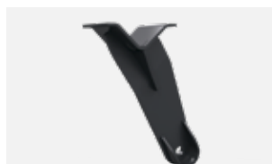
Wspornik talerzy typu STRENX ułatwia transport mas gleby pomiędzy rzędami talerzy (dotyczy szczególnie dużej ilości resztek poźniwnych)
