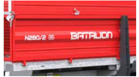
Praktyczne burty umożliwiające łatwą wymianę elementu oraz rozbudowę. Dodatkowo wzmocnione wspornikiem stabilizującym
