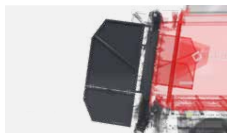
Deflektory mechaniczne (klapy, osłony) kierunku rozrzutu obornika (verti X4)
