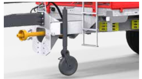
Stopka mechaniczna z kółem stalowym - ułatwia przemieszczanie maszyny i zapewnia jej stabilność podczas użytkowania.
