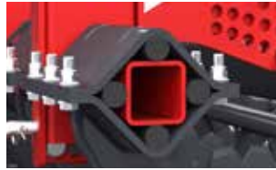
Amortyzatory gumowe \varnothing 50 zapobiegają możliwości trwałego odkształcenia ramienia STRENX
