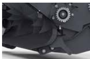
Podłoga rotora opuszczana hydraulicznie - w przypadku powstania zatorów, ułatwia usunięcie blokującego materiału
