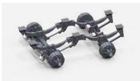
Zawieszenie Tandem z resorem 4 piórowym
