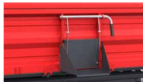
Szyber z rynną - daje możliwość precyzyjnej regulacji przepływu materiałów, co umożliwia łatwe i efektywne rozładunek zbiorów
