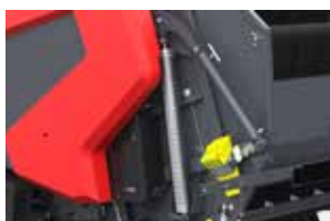
Zgniot materiału - połączenie systemu mechanicznego z hydraulicznym w celu uzyskania równomiernego stopnia nacisku na zwijany materiał niezależnie od średnicy zwijanej beli
