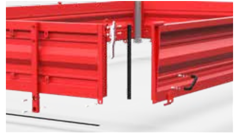
Przyczepy posiadają specjalne uszczelki które zapewniają odpowiednią szczelność
