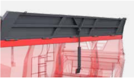
Nadstawy pełne 0,5 m podnoszone hydraulicznie
