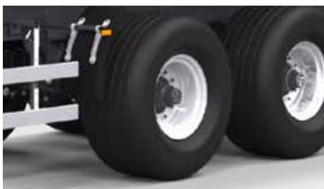
Standardowo opony 560/60-R22,5 (RADIALNE -konstrukcja opony wzmocniona)
