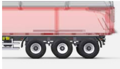
Zawieszenie 3 osiowe - TRIDEM z resorem 4 piórowym
